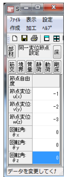
図 6 節点同一化のための自由度設定
