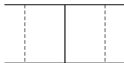
図 6 耐震壁の 1 本柱モデル
