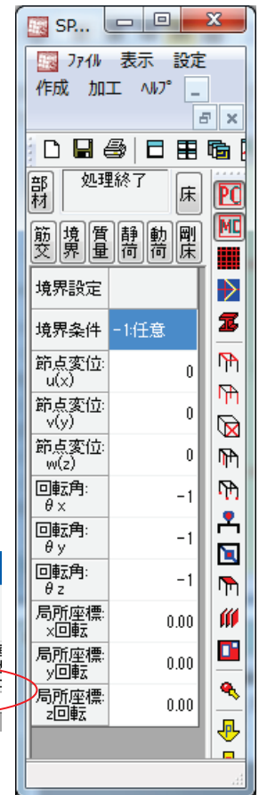
図14 トラス構造の解析のための境界条件設定
